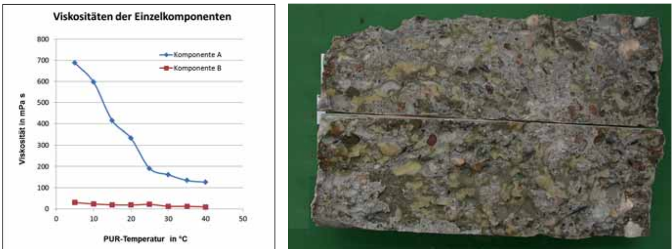
Bild 2: Viskosität der PUR-Komponenten A und B in Abhängigkeit der Temperatur [7] (li), erhärtetes PUR (re)
