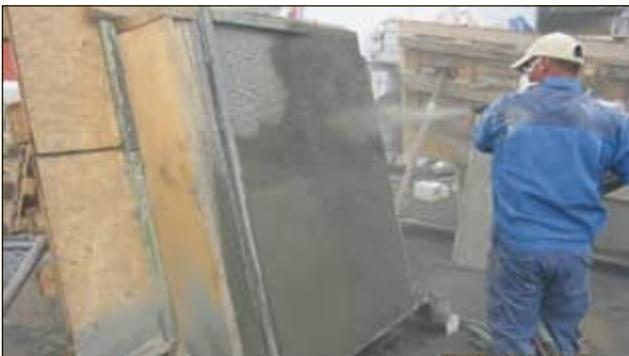
**Bild 3:** Spritzversuche / Eignungsprüfung
