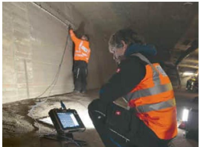
**Bild 2:** Zerstörungsfreie Radarmessungen zur Erkundung von Spannglied- und Bewehrungsverläufen, Aufbauten und Gefügeeigenschaften
