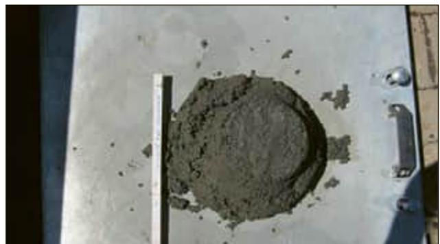
**Bild 6:** Eigenüberwachung Ausbreitmaß
