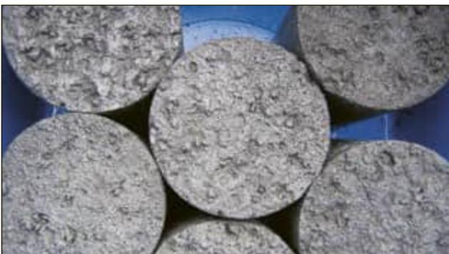
**Bild 5:** Bohrkern mit sichtbarem Stahlfaseranteil
